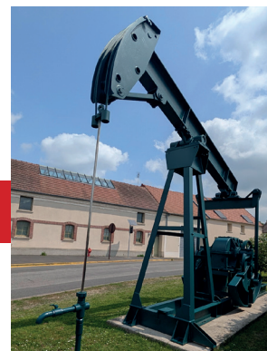
Chevalet de pompage
